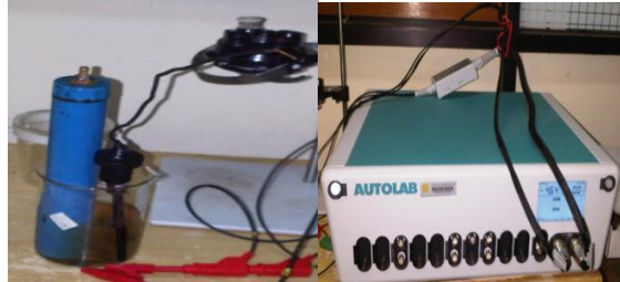
Alat sel polarisasi dan perangkat lunak AUTOLAB
