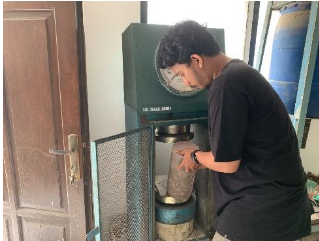
Gambar 5. Proses Pengujian Kuat Tekan Beton
