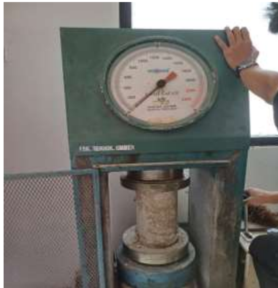
Gambar 4. Proses Pengujian Kuat Tekan bata Ringan
